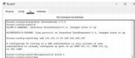
Gambar 12. Konfigurasi interface VLAN 5 pada Router
